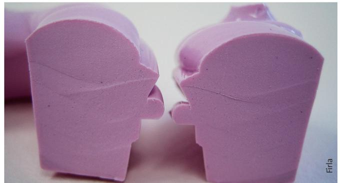
**Abb. 8** Es zeigen sich keine Beeinträchtigungen des abge bundenen Materials durch die Abbinde verhindernde Einflüsse, zum Beispiel durch mit Latex gepuderte Handschuhe oder eingecremte Handoberflächen.
